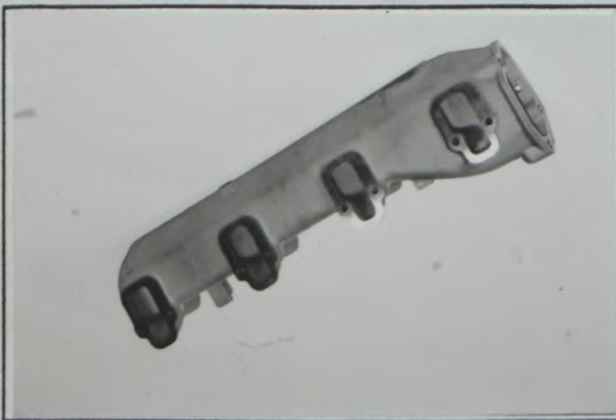
f) Collecteur d'admission Intake manifold
