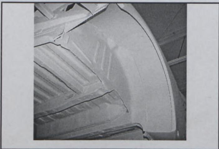
A8) Pièces démontées du passage de roue arrière
