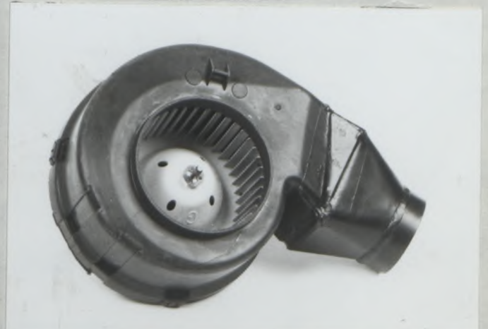
Ventilateur électrique soufflant en amont du turbo
