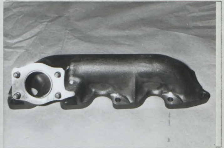
J) Collecteur d'échappement Exhaust manifold
