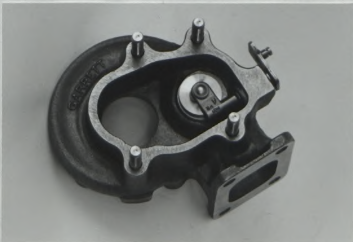
O) Soupape et montage du by-pass du turbocompresseur Valvola e montaggio del by-pass del turbocompressore
