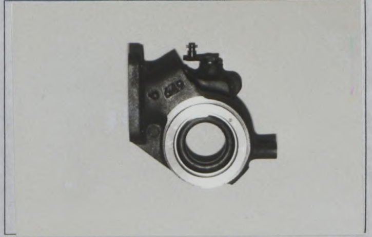
N) Turbine housing of turbocharger ターボチャージャーのタービンハウジング
