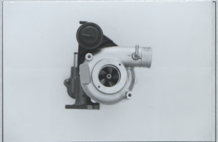
L) Vue de face du turbocompresseur Front view of turbocharger ターボチャージャーの前面視
