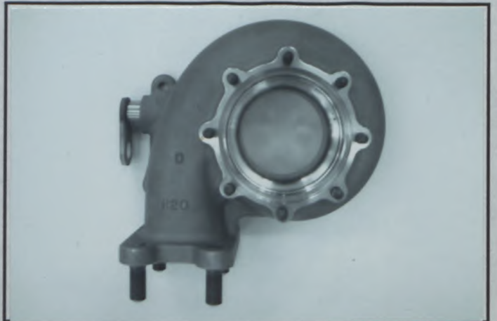
P) Système d'échappement entre collecteur et turbocompresseur Exhaust system between manifold and turbocompressor ターボコンプレッサとマニホールド間の排気方式
