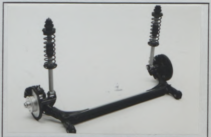
U) Train arrière complet déposé Complete dismantled rear axle
