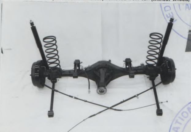
Photo G リヤーブレーキ、ドラムを取外す。 Rear brake, drum removed.
