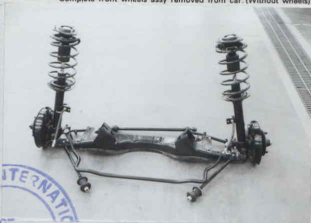
Photo F ディスクの場合はキャリパー付。 Front brake, disc with calliper(s).
