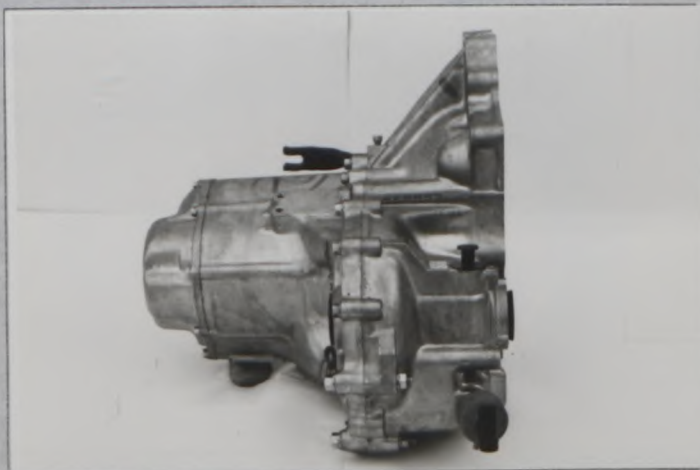
S) Gearbox casing and clutch bellhousing ギヤボックスケースとクラッチハウジング
