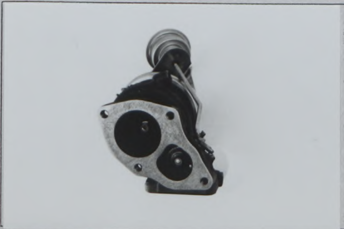
O) Soupape et montage du by-pass du turbocompresseur Valve and by-pass installation of turbocharger 11"47"と11"41"のターボチャージャーへの取付位置
