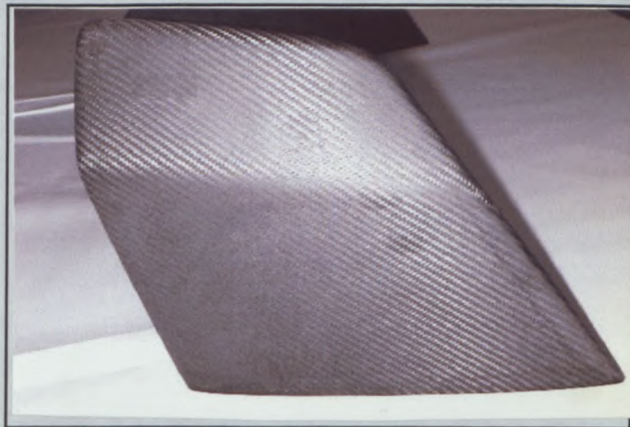
A4) Passage de roue avant avec les pièces montées Front wheel arch with assembled parts 部品を組み付けたフロントホイールアチ
