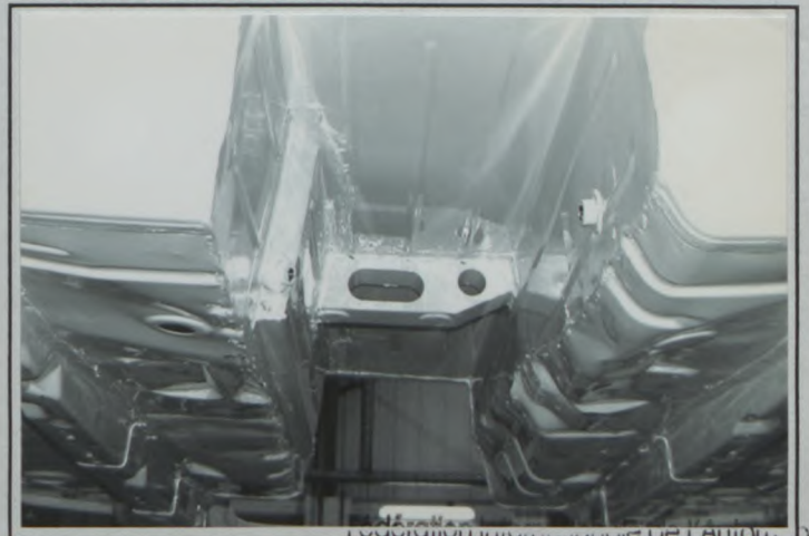
A12) Tunnel de transmission avec les pièces montées Transmission tunnel with mounted parts 部品を組み付けたトランスミッションネル
