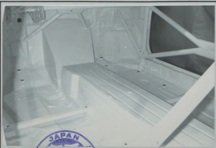
A11) Tunnel de transmission avec les pièces montées Transmission tunnel with mounted parts 部品を組み付けたトランスミッションネル
