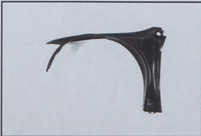
A5) Passage de roue avant avec les pièces démontées Front wheel arch with dismounted parts 部品を分解したフロントホイールアーチ
