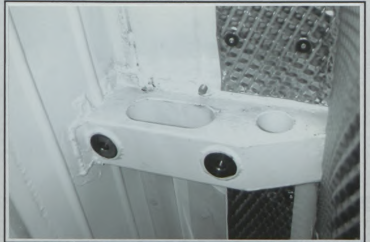
A12) Tunnel de transmission avec les pièces montées Transmission tunnel with mounted parts 部品を組み付けたトランスミッションネル
