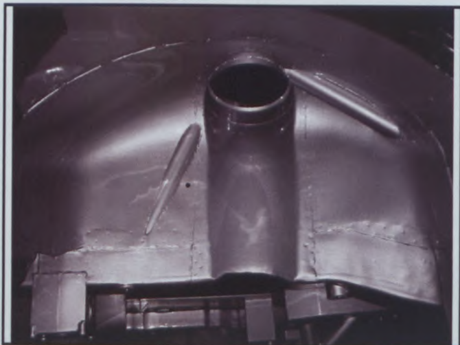
A7) Passage de roue arrière avec les pièces montées Rear wheel arch with assembled parts
