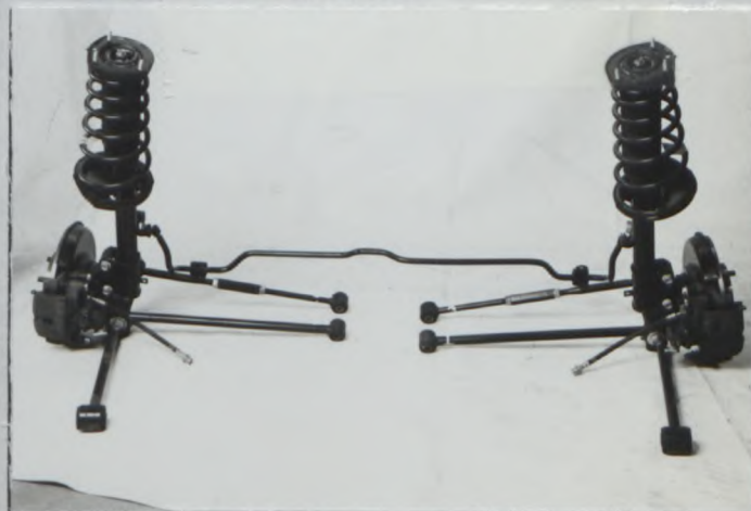
U) Train arrière complet déposé Complete dismantled rear axle
