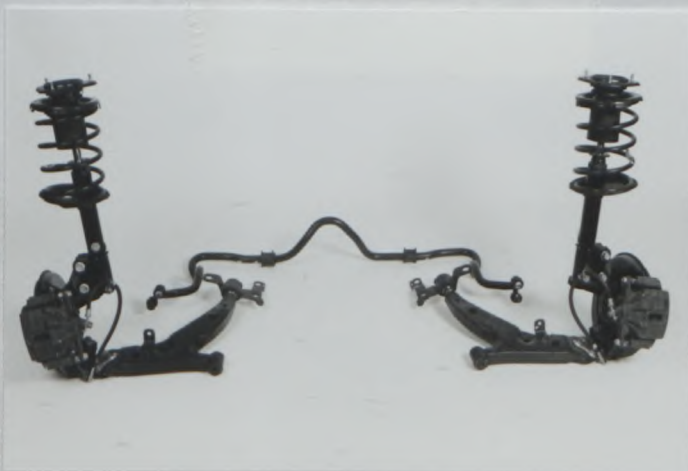
T) Train avant complet déposé Complete dismantled front axle
