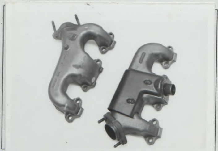
J) Collecteur d'échappement Exhaust manifold
