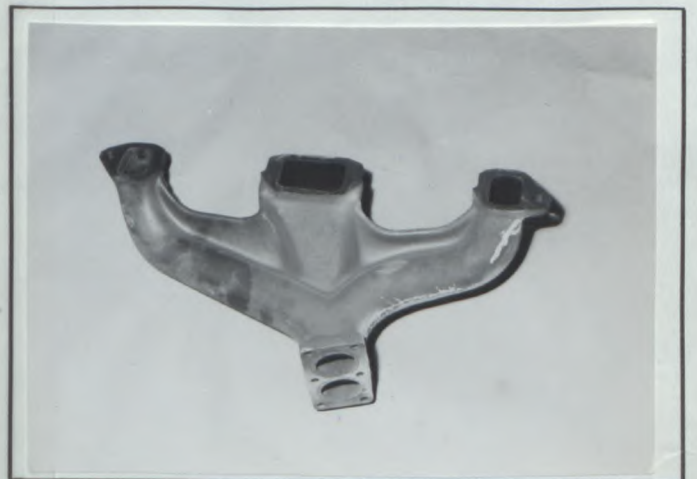
J) Auspuffkrümmer Exhaust manifold
