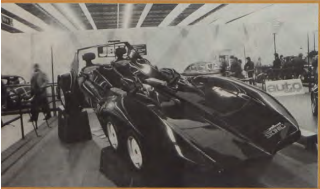
Les attractions du Salon 82 : la Golf à moteur central Porsche réalisée par Franco Sbarro (ci-dessus) et la Wolfrace Sonic, exemplaire unique au monde avec ses six roues, ses deux moteurs Rover 3,5 L. et ses deux cockpits séparés à l'extrême arrière.
