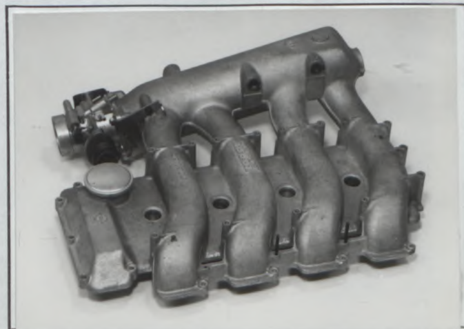
I) Einlaßkrümmer Inlet manifold
