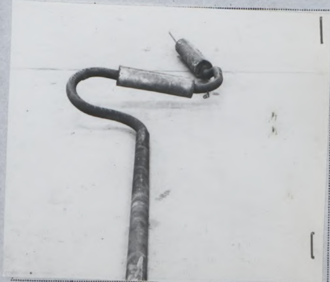
Foto I - Silenziatore di scarico (dopo il collettore).
