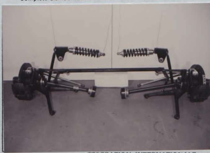
U) Train arrière complet déposé / Complete dismantled rear axle
