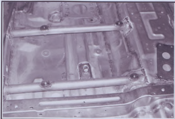
PHOTO N° 9.4 : Harness anchorage point 1
