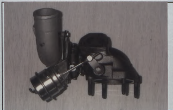
O) Soupape et montage du by-pass du turbocompresseur Valve and by-pass installation of turbocharger
