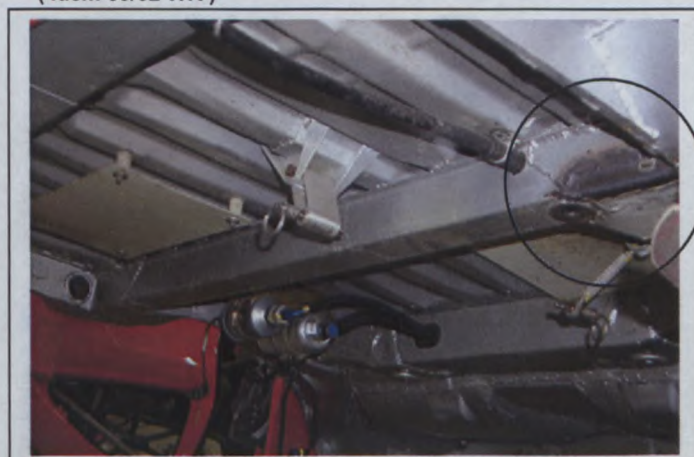
6/ Traverse arrière ( voir photo 7 pour détail modif ) ( Idem 09/02 WR )
