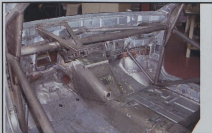
A11) Tunnel avec les pièces montées ( idem 01/01WR ) Tunnel with assembled parts
