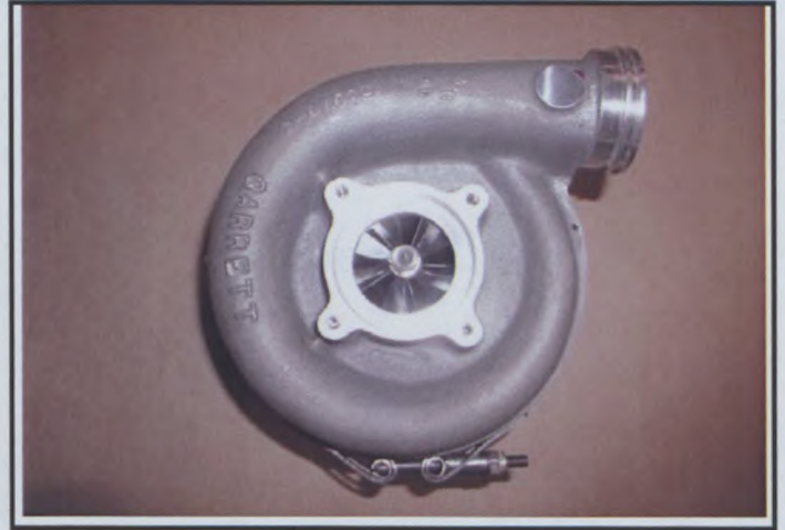
N) Carter de turbine du turbocompresseur ( idem 28/04WR ) Turbine Housing of turbocharger
