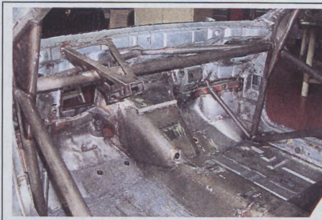
4/ Pièces du tunnel montées
