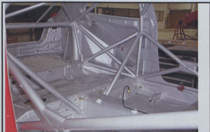
A11) Tunnel avec les pièces montées ( idem 01/01WR ) Tunnel with assembled parts
