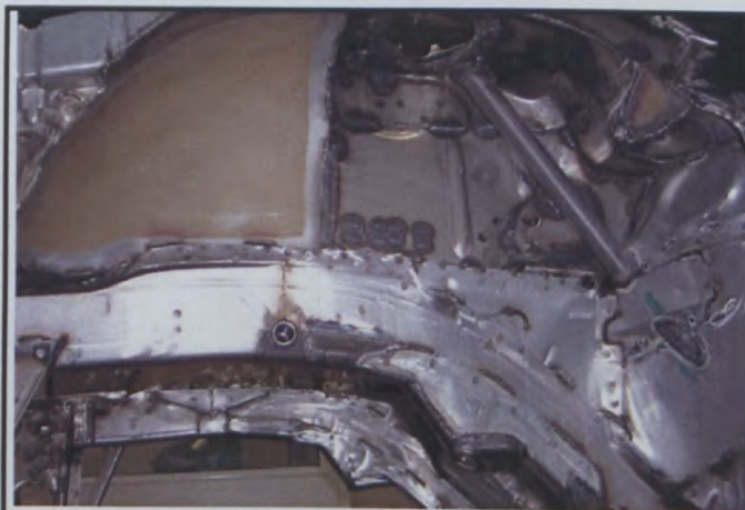
A4) Passage de roue avant avec les pièces montées ( idem 01/01WR ) Front wheel arch with assembled parts
