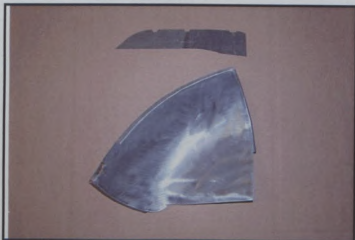
A5) Passage de roue avant avec les pièces démontées ( idem 01/01WR ) Front wheel arch with dismantled parts
