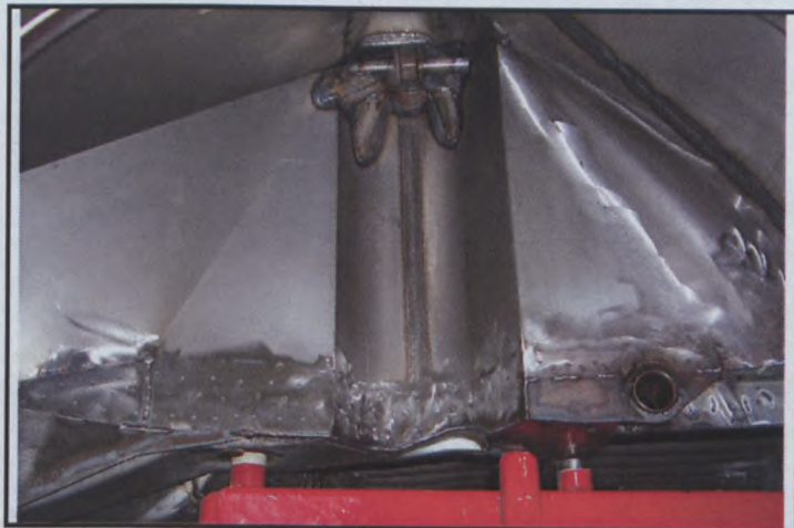
A7) Passage de roue arrière avec les pièces montées ( Idem 01/01 WR ) Rear wheel arch with assembled parts
