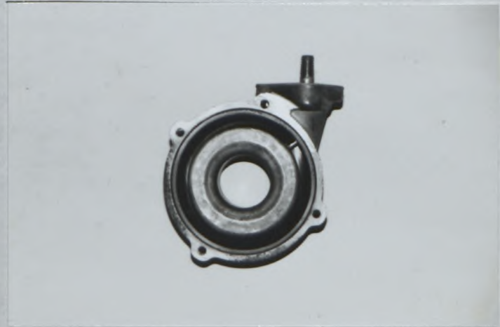
N) Carter de turbine du turbocompresseur Turbine housing of turbocharger ターボチャージターのタービンハウジング
