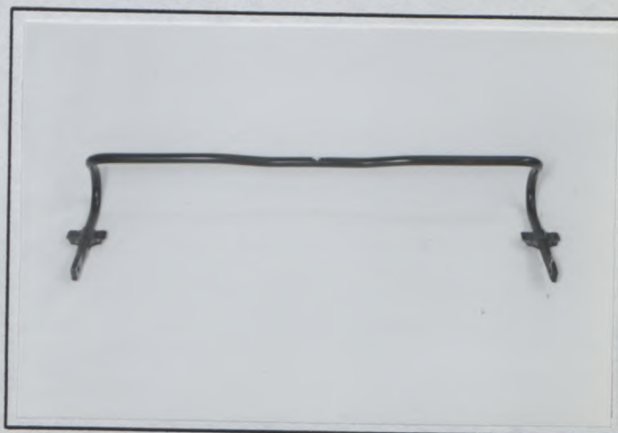
XI) Dessin ou photo du stabilisateur arrière Drawing or photo of rear stabiliser
