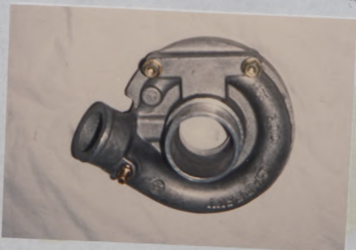
Q) Carter de compression du turbocompresseur Impeller housing of turbocharger
