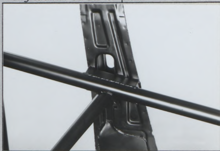
Longitudinal struts to pillar
