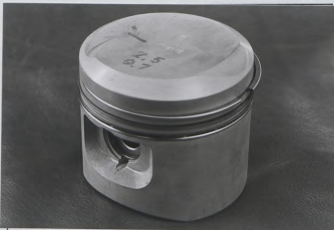
AA) Seitenansicht des Kolbens Piston profile
