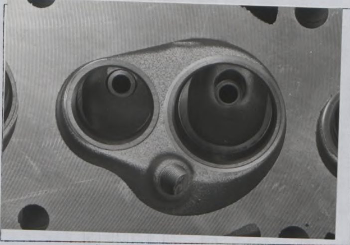
G) Chambre de combustion Combustion chamber
