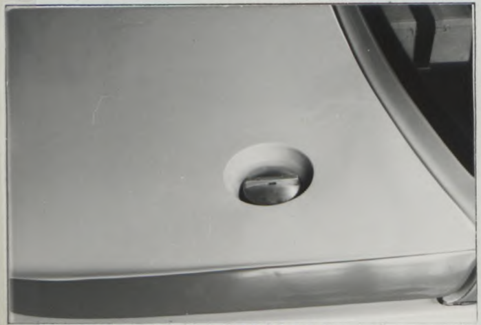
Einfüllstutzen: filling cap
