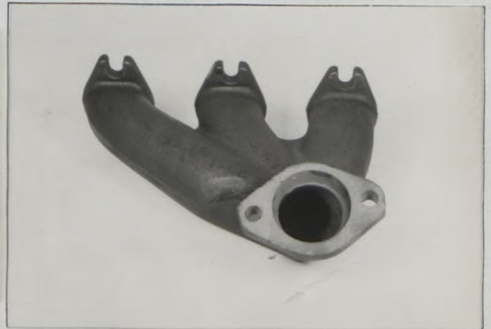
J) Collecteur d'échappement Exhaust manifold
