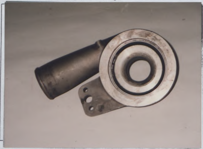
Q) Carter de compresseur du turbocompresseur Compressor housing of turbocharger
