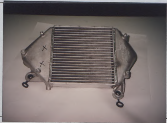
R) Echangeur intermédiaire déposé Intercooler dismantled
