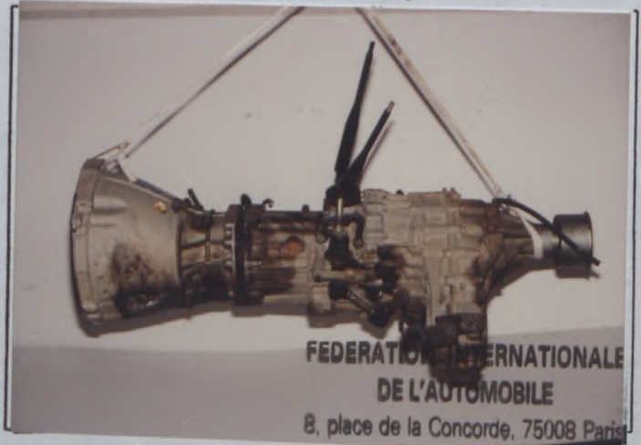
S) Carter de boîte de vitesses et cloche d'embrayage Gearbox casing and clutch bell housing
