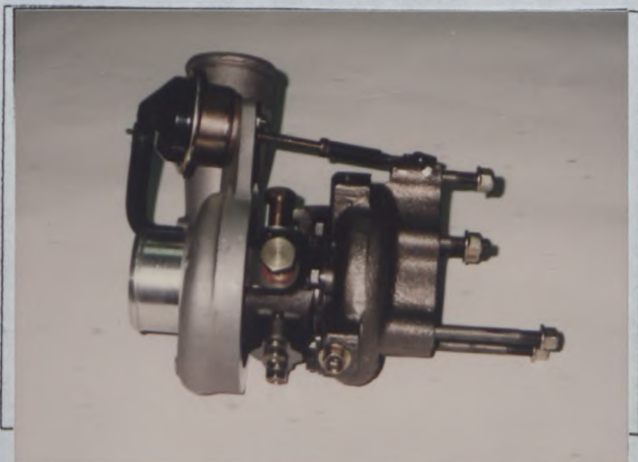
O) Soupape et montage du by-pass du turbocompresseur Valve and by-pass installation of turbocharger
