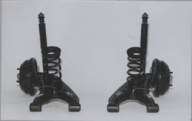
Photo E 車から 取り出した完全なリアサスペンションアッセンブリー (ホイールを除く) Complete rear wheels assy removed from car. (without wheels)
