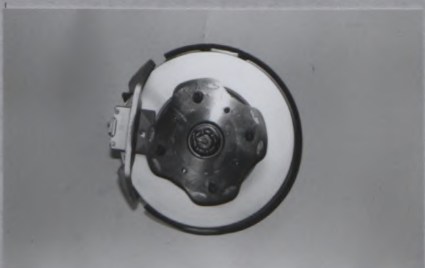
Photo F フロントブレーキ、ドラムを取外す。 ディスクの場合はキャリパー付。 Front brake, drum removed, or disc with calliper(s).
