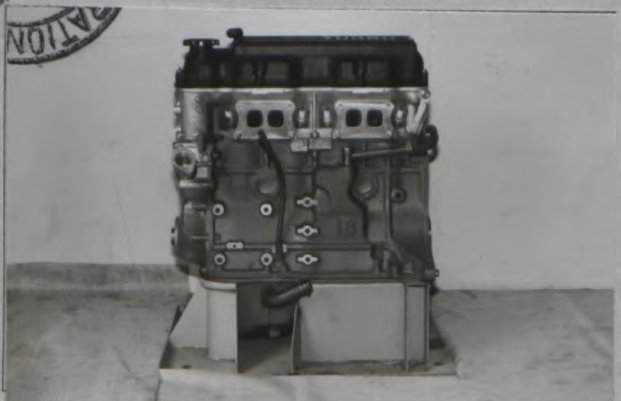
エンジン左側面: エンジン補器、マニホールド、インテーク、ファンを取外す View of the engine, left side, without accessories, without manifold(s) intake nor fan.
