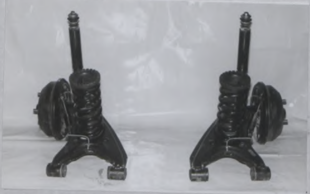
Photo G リアブレーキ、ドラムを取外す。 Rear brake, drum removed.
