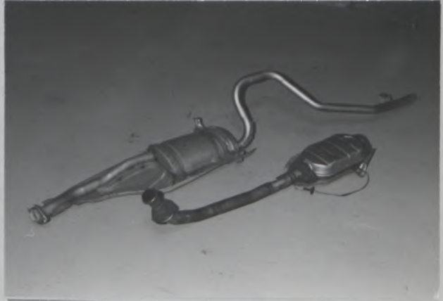
Photo U エキゾーストパイプとマフラー Exhaust piping with muffler.
