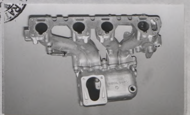
Photo Q インレットマニホールド Inlet manifold.
