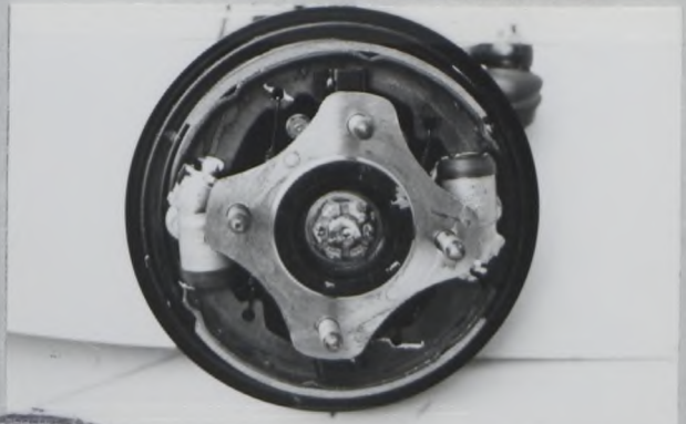
Photo F フロントブレーキ、ドラムを取外す。 ディスクの場合はキャリパー付。 Front brake, DRUM DISK. XXXXXXXXXXXX XXXXXXXXXXXX
