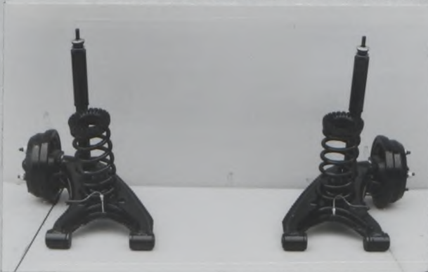
Photo E 車から 取外した完全なリアサスペンションアッセンブリ(ホイールを除く) Complete rear wheels assy removed from car. (without wheels)
