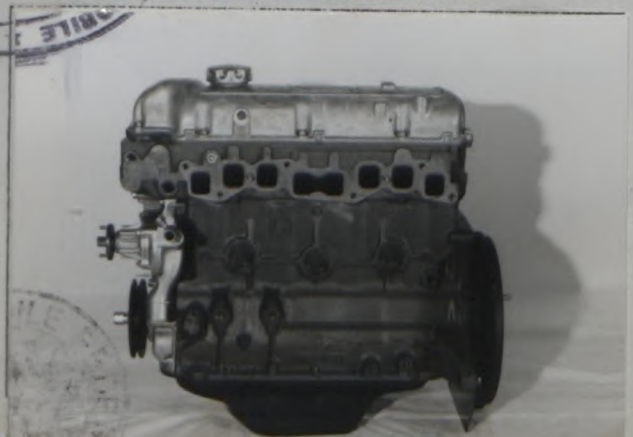
Photo J エンジン左側面: エンジン、センサー、マニホールド、インテーク、ファンを除去し View of the engine, left side, without accessories, without manifold(s) intake nor fan.
