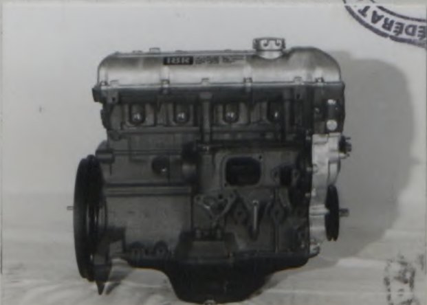
Photo I エンジン右側面: エンジン、センサー、マニホールド、インテーク、ファンを除去し View of the engine, right side, without accessories, without manifold(s) intake nor fan
