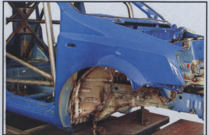
A4) Passage de roue avant avec les pièces montées Front wheel arch with assembled parts
