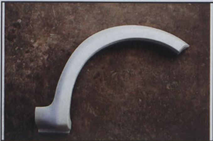
A5) Passage de roue avant avec les pièces démontées Front wheel arch with dismantled parts
