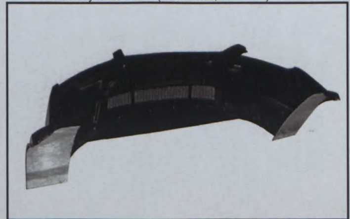
W12) Dispositif aerodynamique avant (démontée, de arrière) Front aerodynamic device (dismounted, back view)
