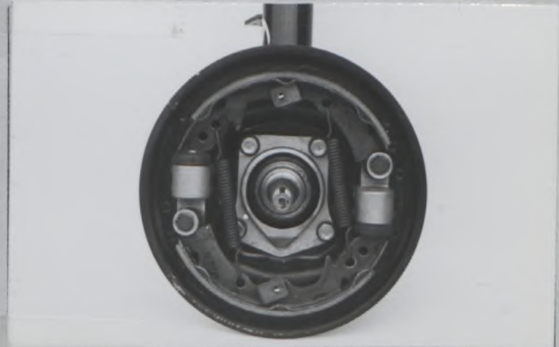
Photo F フロントブレーキ、ドラムを取外す。 ディスクの場合はキャリパー付。 Front brake, drum removed, or disc with calliper(s).
