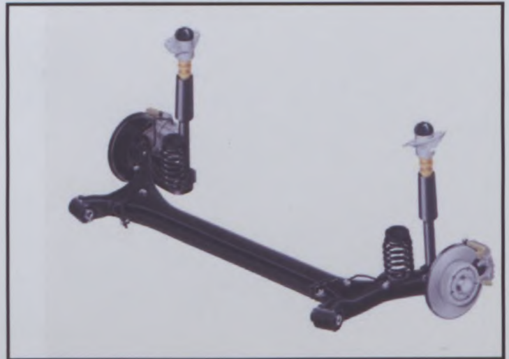
U) Train arrière complet déposé Complete dismantled rear axle
