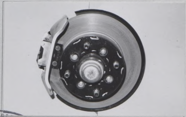
Photo F フロントブレーキ、 ディスク ディスクの場合はキャリパー付。 Front brake, disc removed, or disc with calliper(s).
