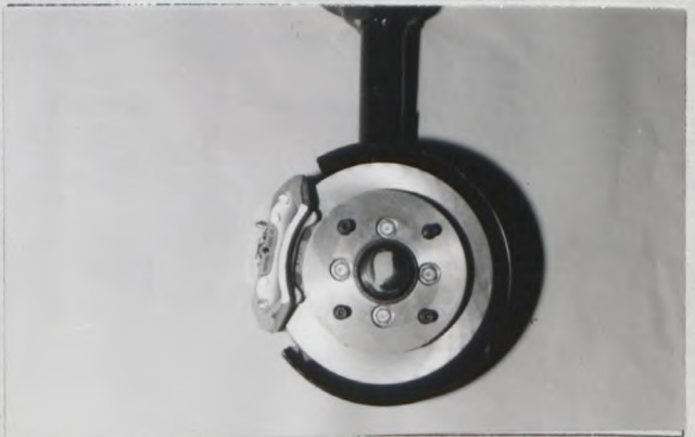
Photo F フロントブレーキ、XXXXXXXXXX ディスクの場合はキャリパー付。 Front brake, XXXXXXXXXXXXX disc with calliper(s).
