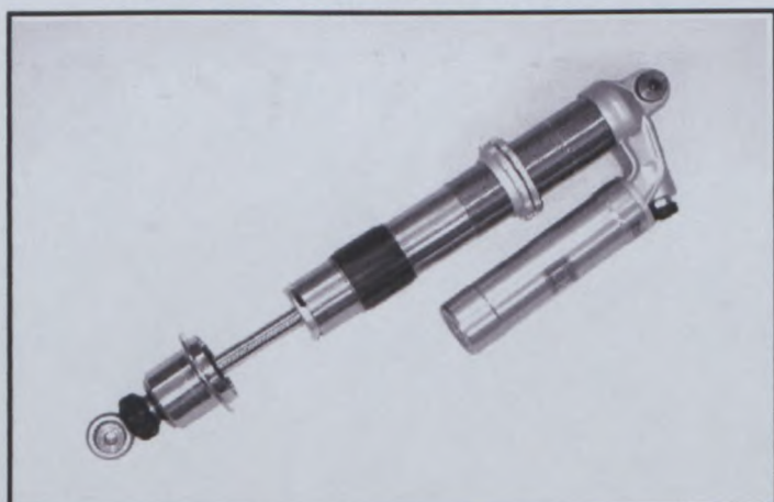
AR1) Amortisseur arrière complet déposé (type 1) Complete rear damper dismantled (type 1)
