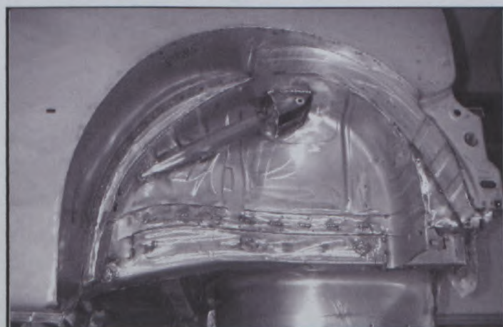
A7) Passage de roue arrière avec les pièces montées Rear wheel arch with assembled parts
