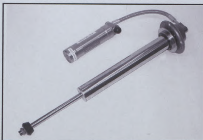
AA2) Amortisseur avant complet déposé (type 2) Complete front damper dismantled (type 2)
