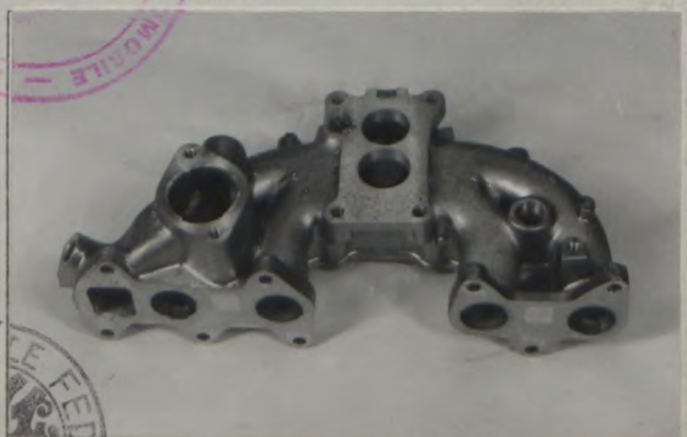
Photo S イントークマニホールド Inlet manifold.
