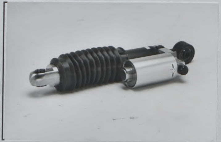
AR2) Amortisseur arrière complet déposé (type 2) Complete rear damper dismantled (type 2) 取り外した完全なリアダンパー (type 2)
