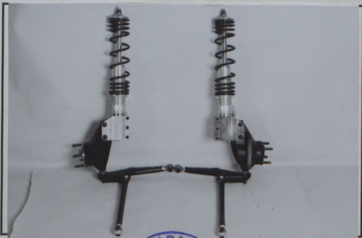
AA3) Train avant complet déposé (avec berceau) Complete dismantled front axle (with front subframe) 取り外したフロントアクスル一式 (フロントサブフレームとともに)
