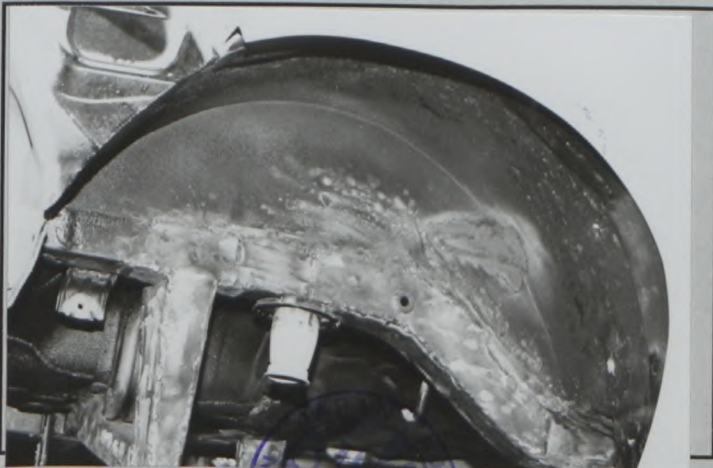
A7) Passage de roue arrière avec les pièces montées Rear wheel arch with assembled parts 部品を組み付けたリアホイールアーチ
