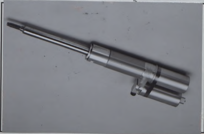
AA1) Amortisseur avant complet déposé (type 1) Complete front damper dismantled (type 1) 取り外した完全なフロントアブソーバ (type 1)
