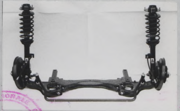
Photo D 車から 取外した完全なフロントサスペンションアセンブリー (ホイールを除く) Complete front wheels assy removed from car. (Without wheels).
