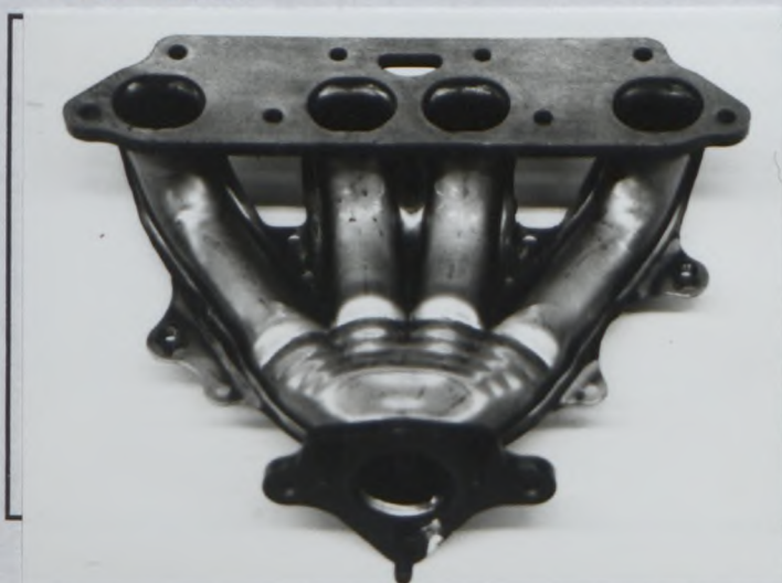
J) Collecteur d'échappement Exhaust manifold
