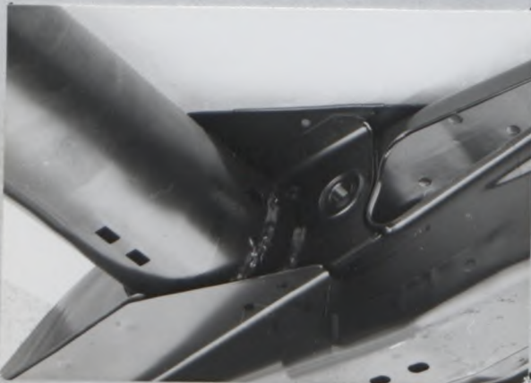
Flasque intérieure épaisseur 4,5 mm
