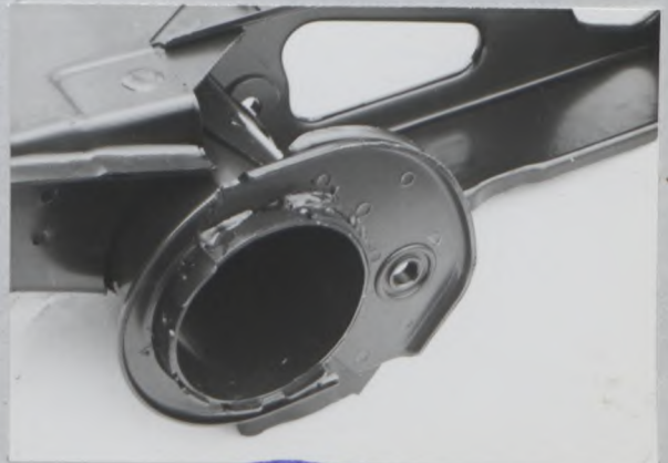
Flasque extérieure épaisseur 4 mm
