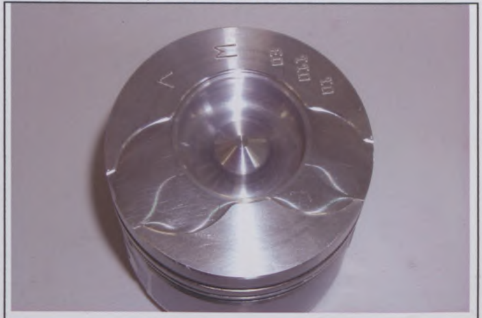
PHOTO N° 4 G) Chambre de combustion
