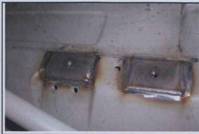
PHOTO N° 19 Точки крепления плечевых лямок ремней безопасности / Safety belts shoulder strap fixing points
